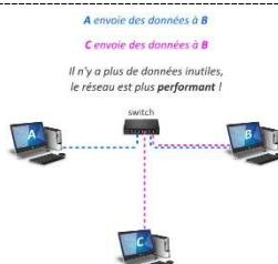
Le commutateur ou switch est un boîtier qui se compose de plusieurs ports réseau au format RJ 45.
