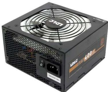
L'alimentation, c'est la centrale électrique de l'ordinateur. Elle reçoit le courant 220 Volts et le converti en 12 Volts qui est le voltage des composants qui sont à l'intérieur de l'unité centrale. Des câbles colorés en sortent pour aller alimenter chaque élément de l'unité centrale.
