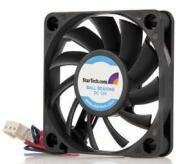
L'électronique, ça chauffe et pas qu'un peu. Pour éviter une température trop haute à l'intérieur de votre unité centrale, des ventilateurs et radiateurs sont placés stratégiquement pour refroidir les composants. Attention, la poussière est l'ennemie des ventilateurs. Elle se glisse dans les pales, les empêchent de bien tourner et gardent la chaleur comme le font les radiateurs à la maison... Accumuler la chaleur quand on cherche à refroidir, ce n'est pas génial !
