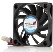
L'électronique, ça chauffe et pas qu'un peu. Pour éviter une température trop haute à l'intérieur de votre unité centrale, des ventilateurs et radiateurs sont placés stratégiquement pour refroidir les composants. Attention, la poussière est l'ennemie des ventilateurs. Elle se glisse dans les pales, les empêche de bien tourner et gardent la chaleur comme le font les radiateurs à la maison... Accumuler la chaleur quand on cherche à refroidir, ce n'est pas génial !
