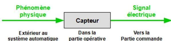
**Un capteur** est un élément de la partie opérative qui détecte un phénomène physique dans son environnement. Il réagit donc en fonction d'une grandeur physique (présence, distance, niveau, débit, masse, pression, vitesse, accélération, température, luminosité, humidité...).
