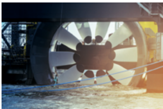
Hydrolienne sur une plateforme de test à Halifax (Nouvelle-Écosse, Canada)
